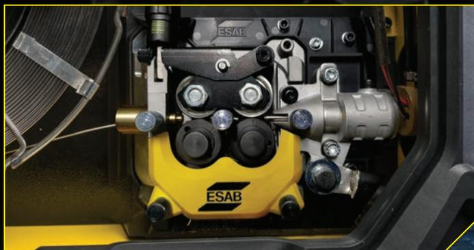
4-роликовый механизм подачи обеспечит плавную и стабильную подачу проволоки любого диаметра со скоростью 20.3 м/мин.
